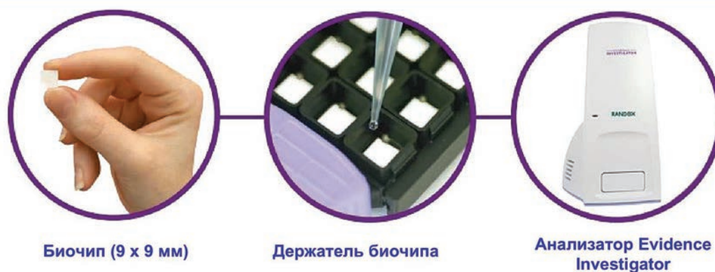
Рис. 11. Биочип и анализатор Evidence Investigator компании Randox для обнаружения SARS-CoV-2
